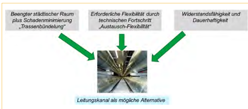
Abb. 02: Unterirdische, meist begehbare Leitungskanäle als »smarte« Lösungsalternative
