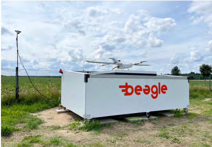
Abb. 03: Auf einem eigenen kleinen Hangar wird die Drohne in der Nähe des Einsatzorts geparkt und ist jederzeit schnell verfügbar. [Foto: Beagle Systems]
