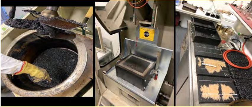
Abb. 03: Herstellung der Probeplatten; links: Mischgutherstellung, Mitte: Walzsektor-Verdichtungsgerät, rechts: Probeplatten [Quelle: Triflex]
