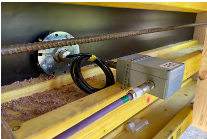
Abb. 04: Eingebauter und verkabelter Drucksensor [Quelle: A. J. Taraboj]
